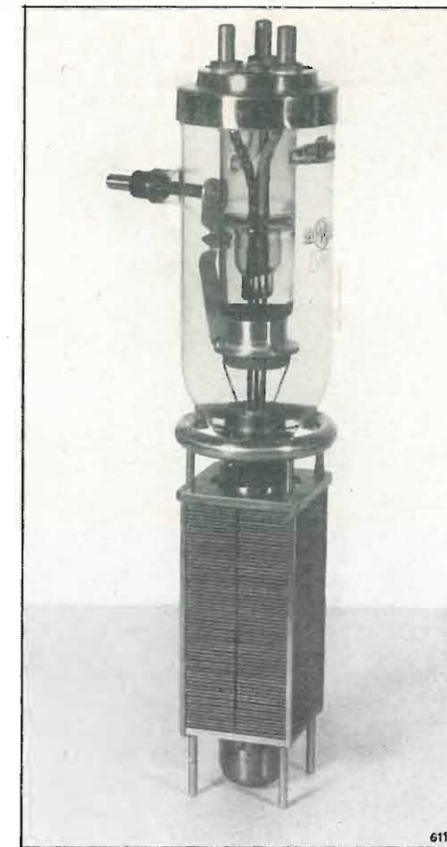
Fig. 7. — Radiatore ad alette triangolari applicato a un triodo 892.
