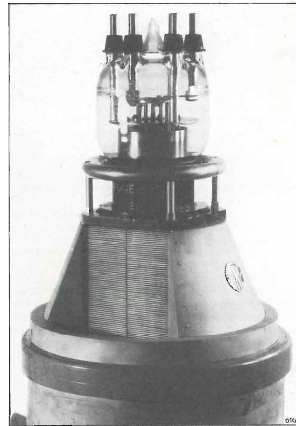
Fig. 12. — Radiatore ad alette triangolari munito di solo adattatore per il raffreddamento con aria aspirata.
